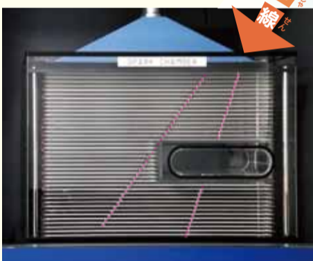
▲宇宙からの放射線「宇宙線」を光で見ることができる装置
