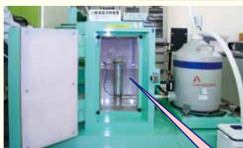
放射線物質を調べるゲルマニウム半導体検出器
