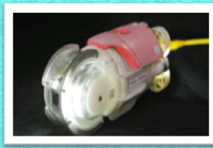
福島第一原子力発電所水中調査ロボット (IRID・東芝エネルギーシステムズ)
